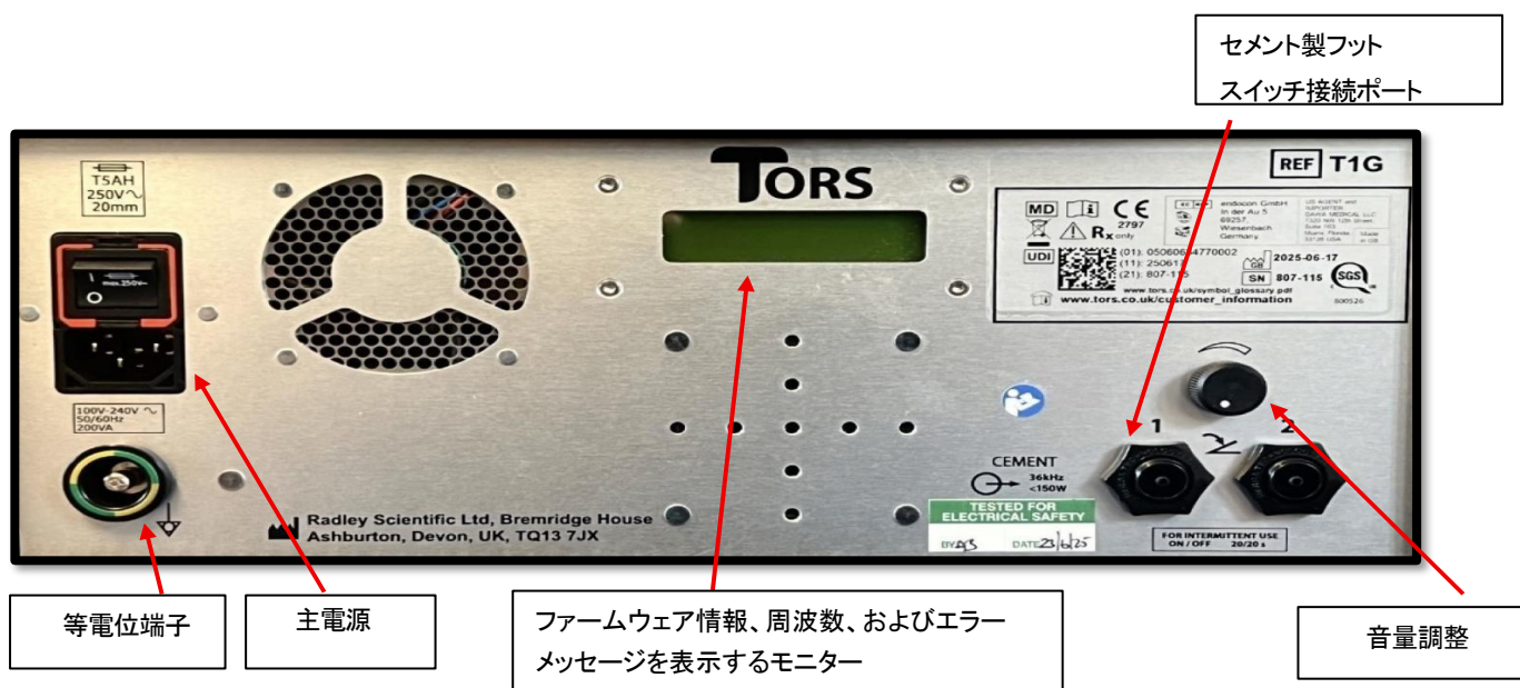
図2：TORS ジェネレーター後部パネル
